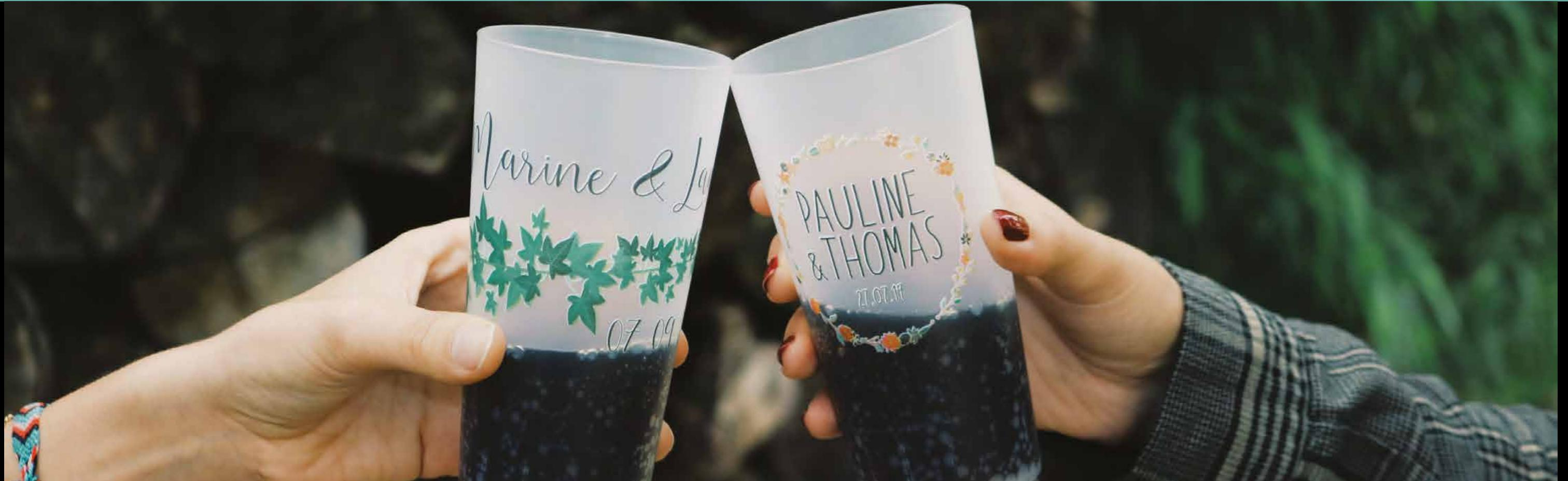
**Ситопечат** - метод за печатане, при който мастилото се нанася върху материала чрез мрежа с отвори, която се нарича сито. Мрежата се поддържа твърдо върху рамка и се преминава през нея мастилото с помощта на скребец. При този процес мастилото се прехвърля от отворите на мрежата върху материала, който се печата. Този метод се използва за печатане на различни материали, в случая върху пластмасови чаши. Подходящ в за лога с 1 и 2 цвята.
